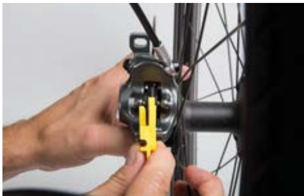
Figura 146: Comprobación de la almohadilla de freno montada con ayuda del seguro de transporte
