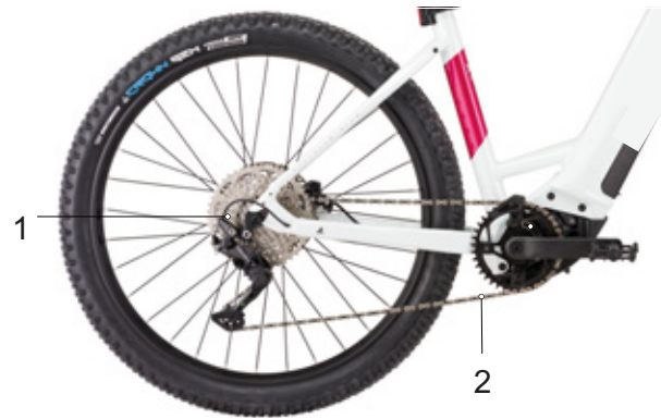
Figura 26: Esquema de la transmisión por cadena con cambio de cadena
