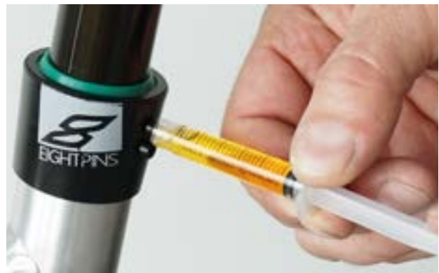
Figura 142: Lubricación del tubo de la tija de sillín
