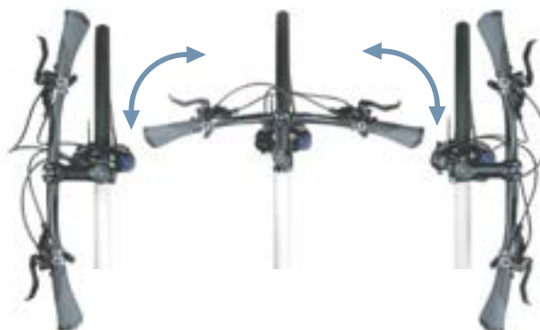
Figura 4: Función de giro, ejemplo BY.SCHULZ
