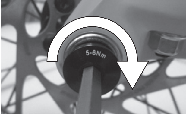
31. ábra: A rögzítőcsavar meghúzása
