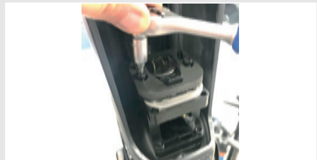
22. ábra: Akkumulátortartó csavarok oldása
