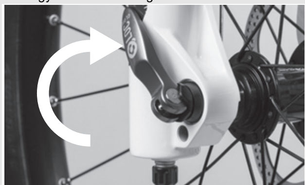
43. ábra: A gyorszár zárása
