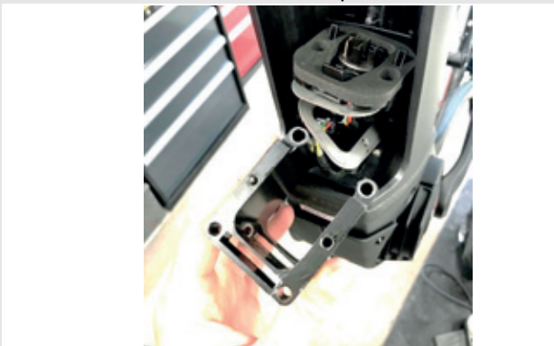
25. ábra: A PowerTube adapter kihúzása
