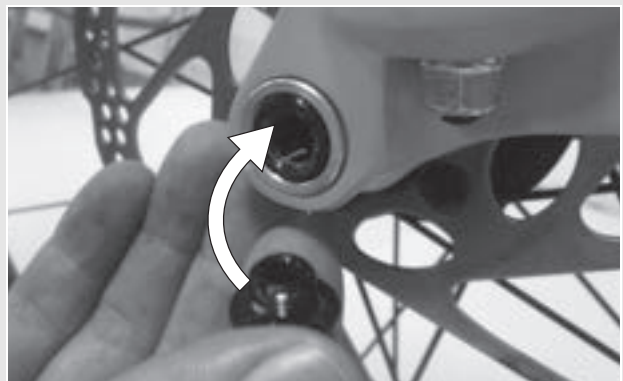
30. ábra: A gyorskioldó kar betolása a tengelybe
