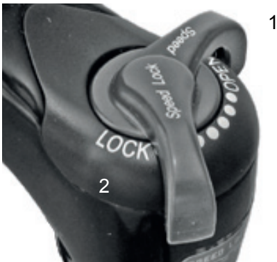
64. ábra: Suntour nyomásfokozat-beállító OPEN (1) és LOCK (2) pozíciókkal
