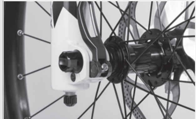
38. ábra: A gyorskioldó kar tökéletes helyzete
