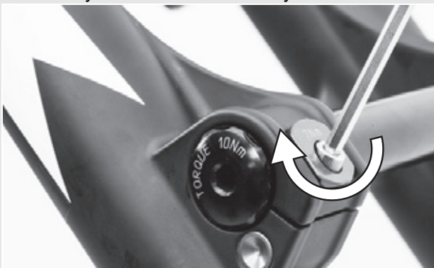
33. ábra: A rögzítőkapocs meghúzása
