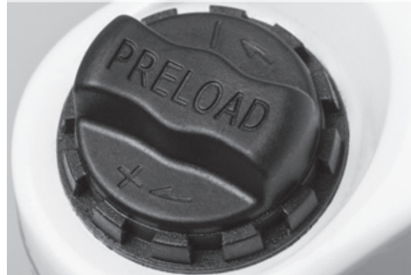
55. ábra: A negatív rugóút beállító kereke a teleszkópos villa koronáján
