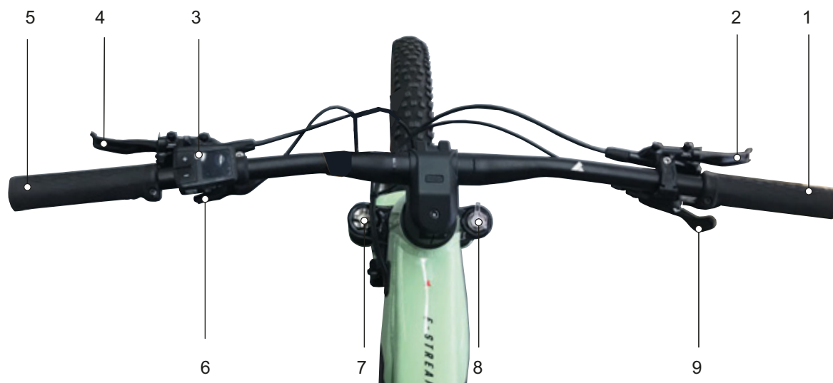
Rysunek 36: Widok szczegółowy kierownicy z komputerem pokładowym Remote LCD firmy FIT, przykład
