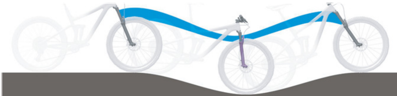
Rysunek 201: Zbyt miękkie amortyzowanie widelca na wzniesieniu
