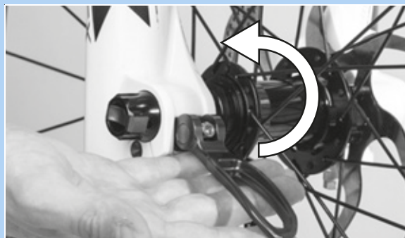
Rysunek 72: Docisnąć dźwignia zacisku szybkomocującego zgodnie z kierunkiem strzałki
