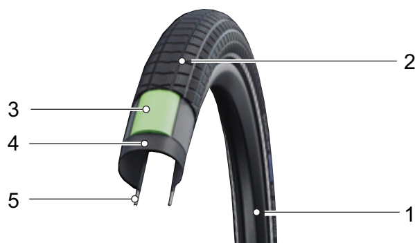
Rysunek 18: Budowa opony otwartej
