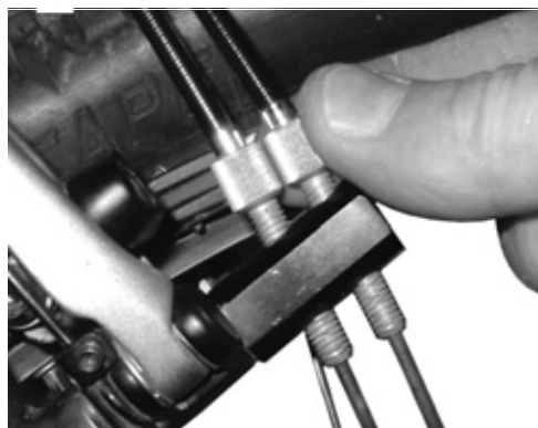
Rysunek 189: Wersje piasty ROHLOFF z wewnętrznym sterowaniem zmiany biegów posiadają regulator naprężenia na wsporniku linek
