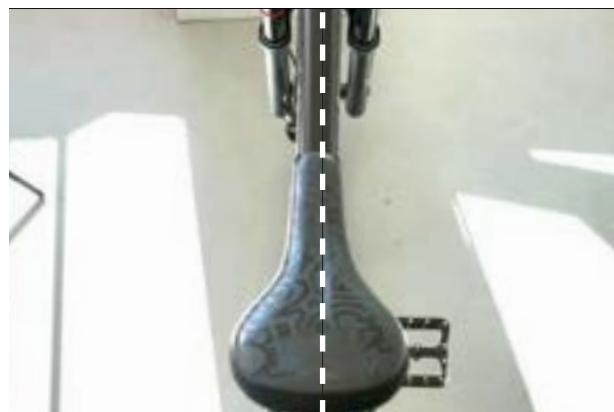
Rysunek 99: Ustawianie siodełka zgodnie z kierunkiem jazdy
