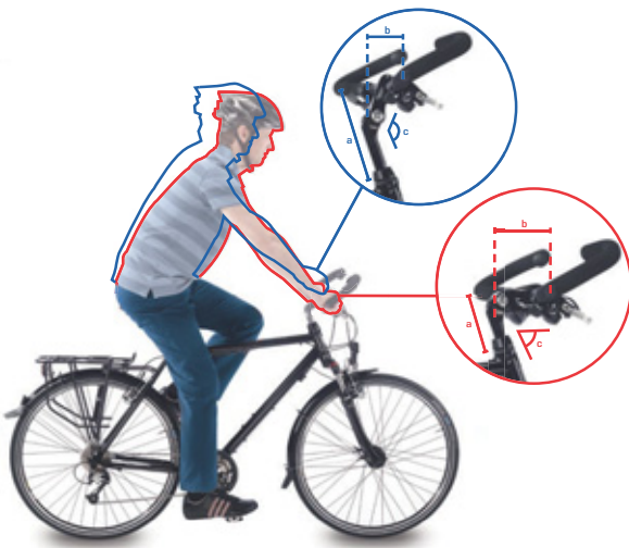
Rysunek 114: Pozycja roweru miejskiego (niebieski) i trekkingowego (czerwony) dzięki regulacji kąta nachylenia
