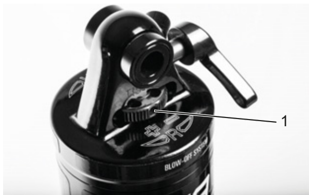
Rysunek 216: Nastawnik odbicia SR SUNTOUR – pokrętło (1) na tylnym amortyzatorze
