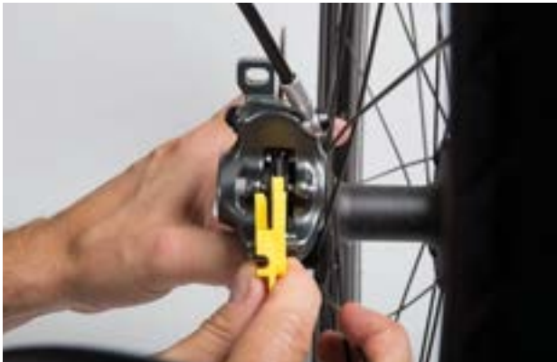
Rysunek 164: Sprawdzać stan klocków hamulca w stanie zamontowanym za pomocą zabezpieczenia transportowego
