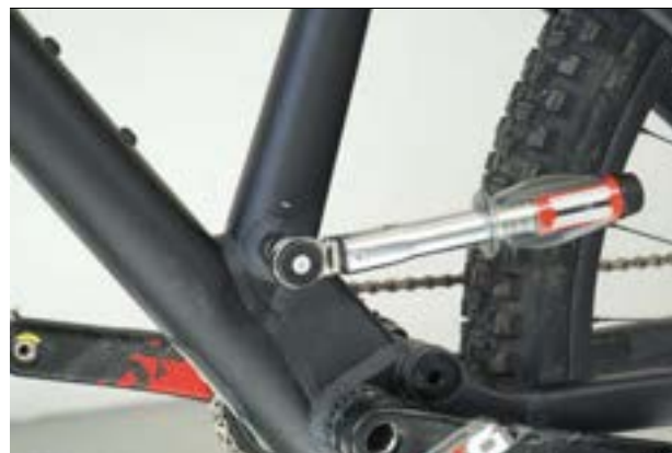
Rysunek 100: Dociąganie osi sztycy podsiodłowej
