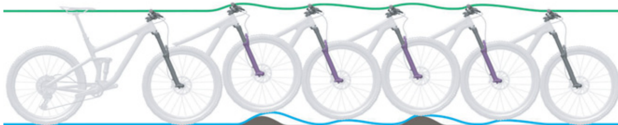
Rysunek 205: Zbyt szybkie rozprężanie widelca amortyzowanego
