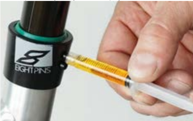
Rysunek 160: Smarowanie sztycy podsiodłowej eightpins
