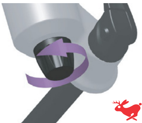
Rysunek 208: Obrócić pokrętko nastawnika odbicia w kierunku symbolu zająca
