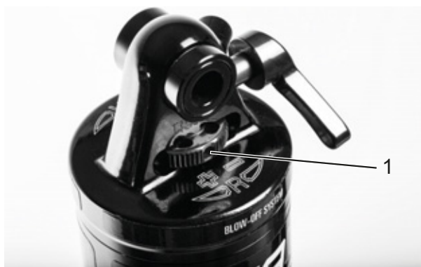
Rysunek 214: Nastawnik odbicia SR SUNTOUR – pokrętło (1) na tylnym amortyzatorze
