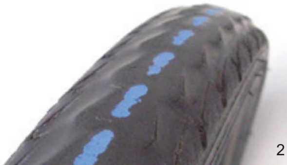
Rysunek 162: Opona bez bieżnika, którą można wymienić (1) i opona z prześwitującą ochroną przed przebicciem (2), którą należy wymienić
