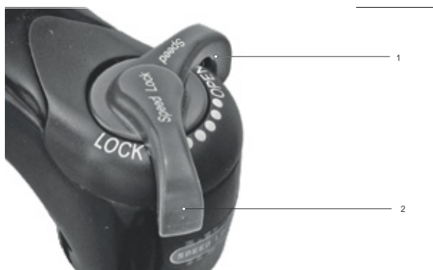
Rysunek 202: Ustawienie nastawnika dobiecia na twardszy tryb pracy
