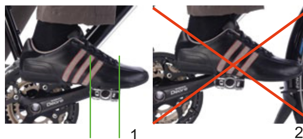
Rysunek 140: Prawidłowe (1) i nieprawidłowe (2) ułożenie stopy na pedale
