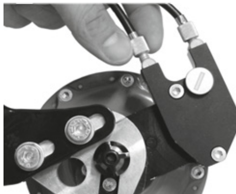
Rysunek 190: Wersje piasty ROHLOFF z zewnętrznym sterowaniem zmiany biegów mają regulator linki na przepustnicy kablowej, która znajduje się po lewej stronie
