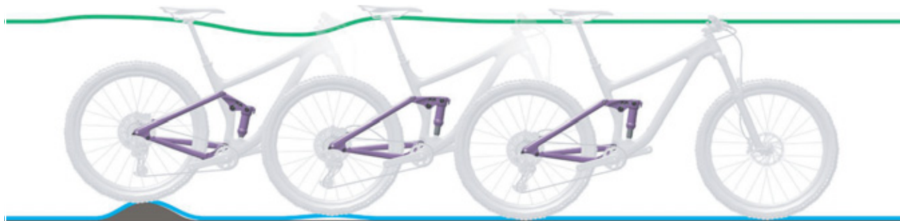
Rysunek 221: Zbyt szybkie rozprężanie się tylnego amortyzatora
