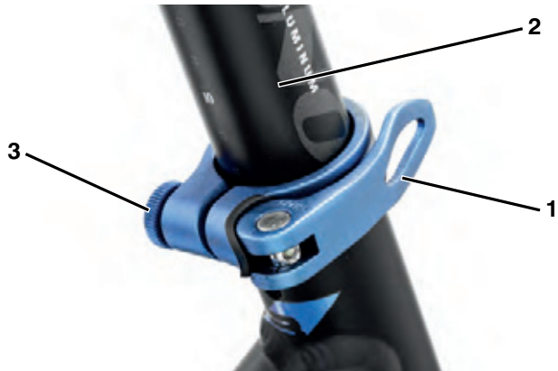
Figura 18: Cierre rápido de la tija de sillín (2) en la posición final de la palanca tensora de la tija de sillín (1) y su tuerca moleteada (3)
