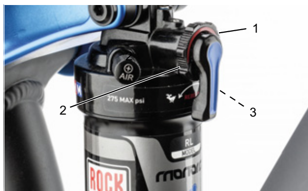
Rysunek 88: Ustawianie twardości tłumika odbicia za pomocą pokrętła regulacyjnego (1)
