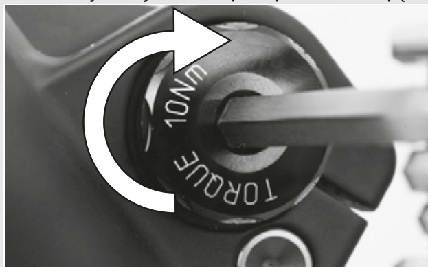
Rysunek 43: Sposób dokręcania włożonej osi
