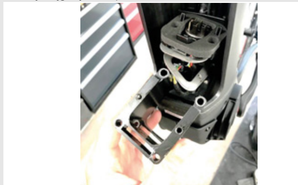
Rysunek 29: Wyciąganie adaptera PowerTube
