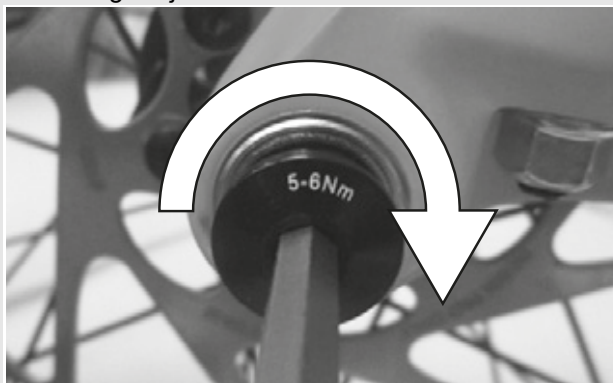
Rysunek 42: Sposób dokręcania śruby zabezpieczającej
