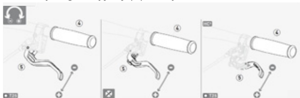
Rysunek 68: Ustawianie odchylenia manetki dźwigni hamulca tarczowego Magura
