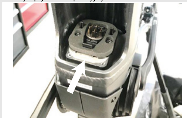
Rysunek 30: Zamontowane płytki adaptacyjne
