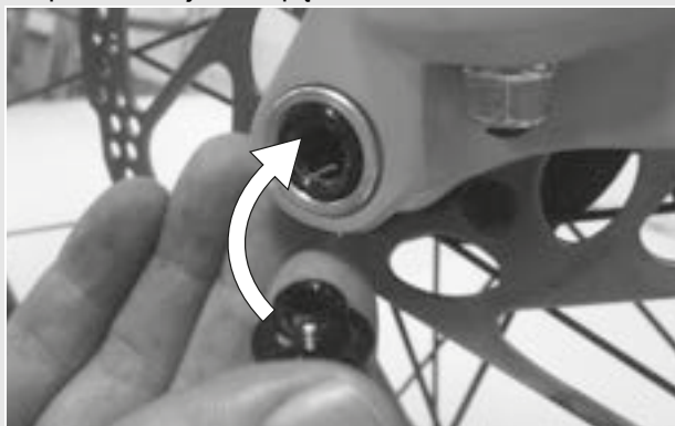
Rysunek 41: Sposób wsuwania dźwigni zacisku szybko mocującego w oś
