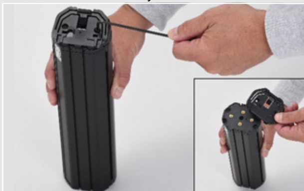
Rysunek 35: Demontaż górnego interfejsu
