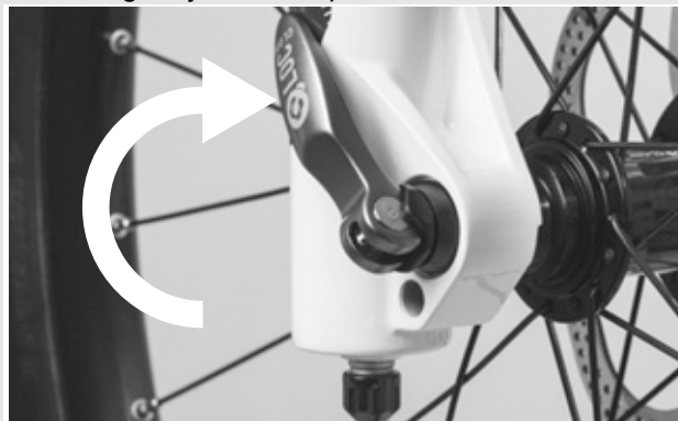
Rysunek 54: Zamykanie zacisku szybko mocującego
