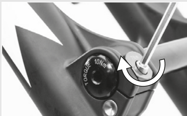
Rysunek 44: Sposób dokręcania zacisku zabezpieczającego
