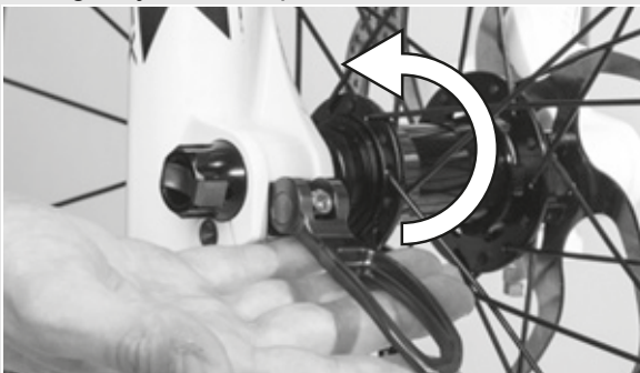
Rysunek 48: Sposób zabezpieczania dźwigni
