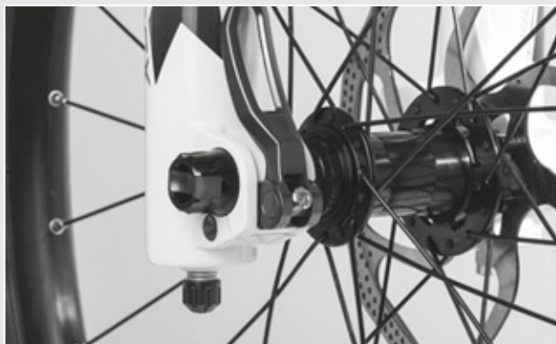
Rysunek 93: Ustawianie siły mocowania zacisku szybkomocującego
