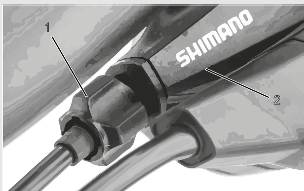
Rysunek 95: Nakrętka regulacyjna (1) jednoczęściowego mechanizmu zmiany przerzutek z obudową dźwigni zmiany biegów (2), przykład
