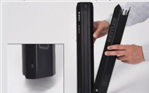
Rysunek 34: Wsuwanie pokrywy na akumulator
