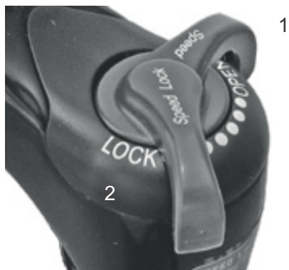
Rysunek 87: Nastawnik dobicia Suntour z pozycjami OPEN (1) i LOCK (2)
