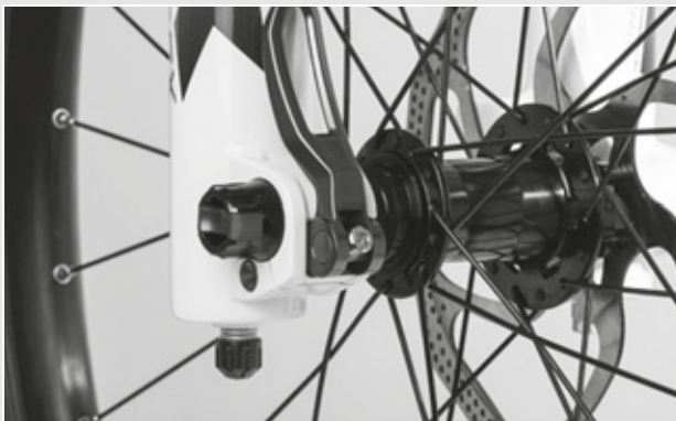
Rysunek 49: Optymalne położenie dźwigni mocującej
