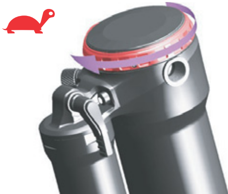
Figura 108: Rotazione dell'ammortizzatore a stadi di trazione in direzione tartaruga
