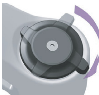
Figura 89: Regolazione più rigida del regolatore dello stadio di compressione
