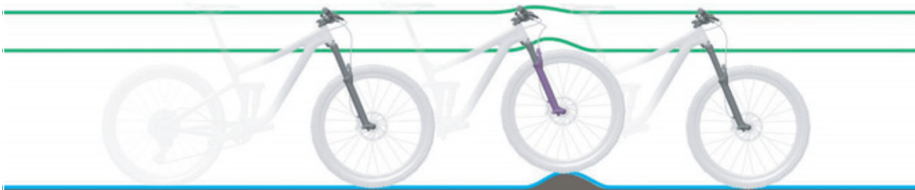
Figura 7: Comportamento di marcia ottimale della forcella su un terreno con asperità
