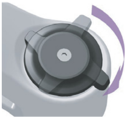
Figura 104: Regolazione più rigida del regolatore dello stadio di compressione
