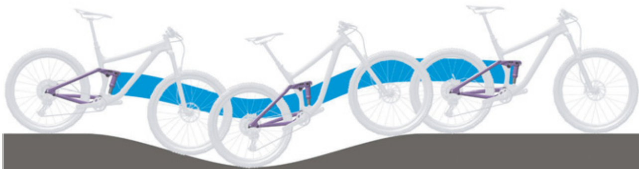
Figura 63: Comportamento di marcia ottimale dell'ammortizzatore del carro posteriore su un terreno con dossi
