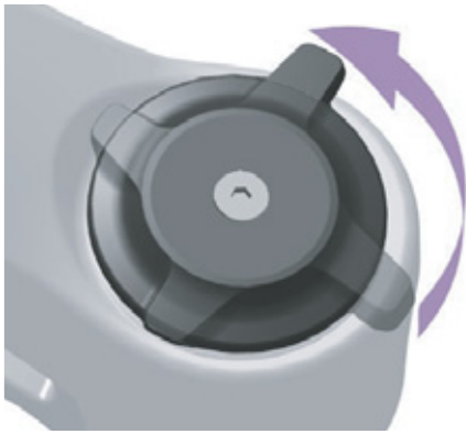
Figura 106: Regolazione più morbida del regolatore dello stadio di compressione
