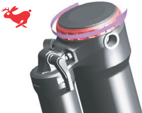
Figura 110: Rotazione dell'ammortizzatore a stadi di trazione in direzione lepre
