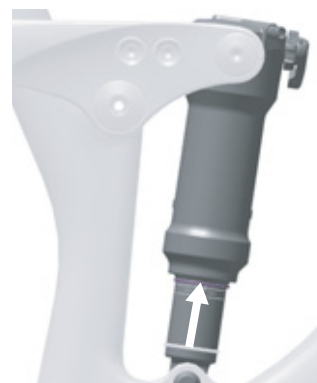
Figura 57: Spostamento dell'O-ring sull'ammortizzatore del carro posteriore
