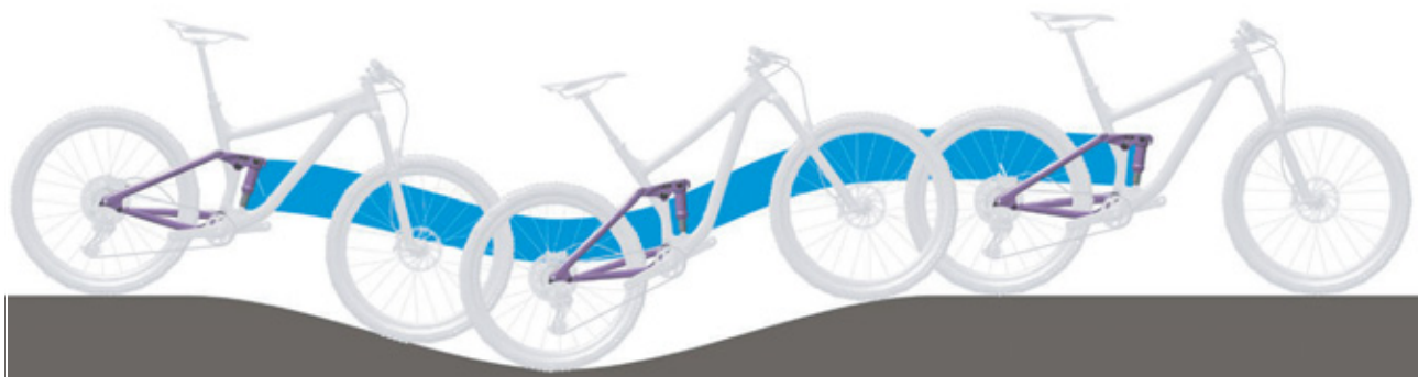
Figura 11: Comportamento di marcia ottimale dell'ammortizzatore del carro posteriore su un terreno con dossi
