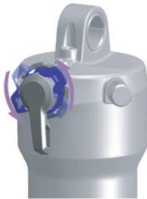
Figura 114: Regolazione più morbida del regolatore dello stadio di compressione
