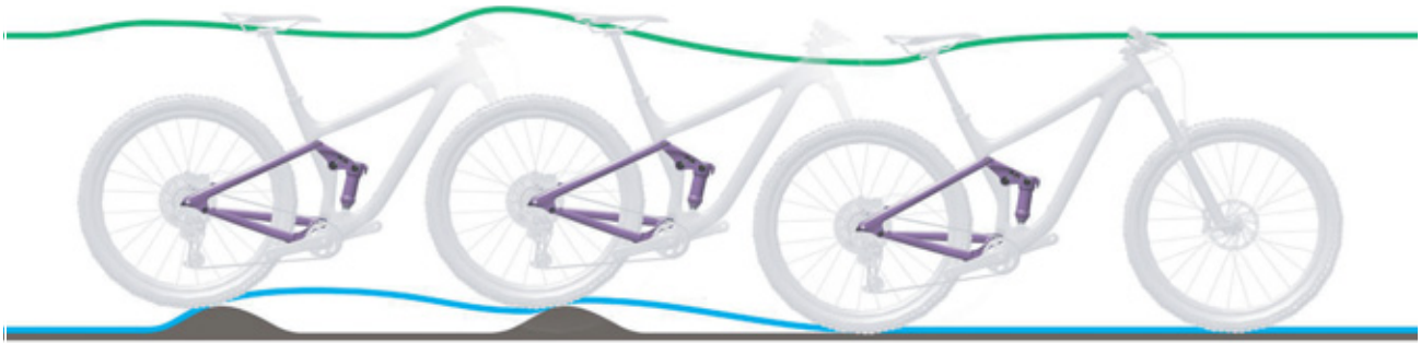
Figura 109: Corsa di estensione troppo lenta dell'ammortizzatore del carro posteriore
