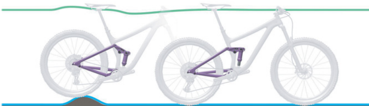
Figura 64: Comportamento di marcia ottimale dell'ammortizzatore del carro posteriore su asperità
