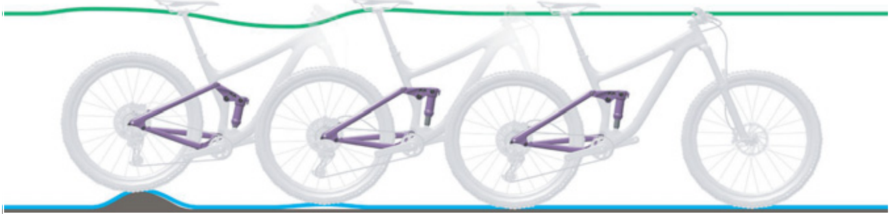
Figura 107: Corsa di estensione troppo veloce dell'ammortizzatore del carro posteriore
