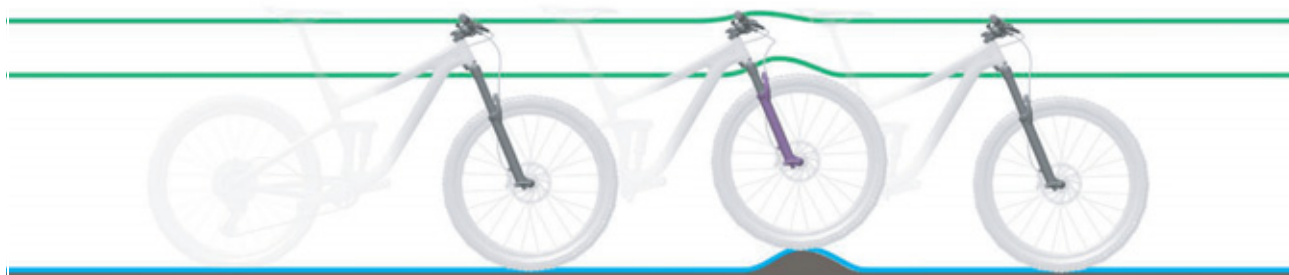
Figura 87: comportamento di marcia ottimale su un terreno con asperità
