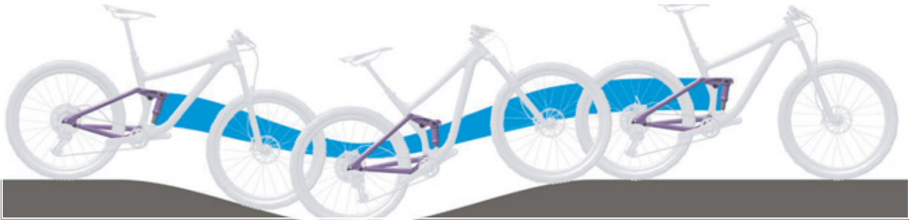
Figura 111: Sospensione dell'ammortizzatore del carro posteriore troppo morbida in salita
