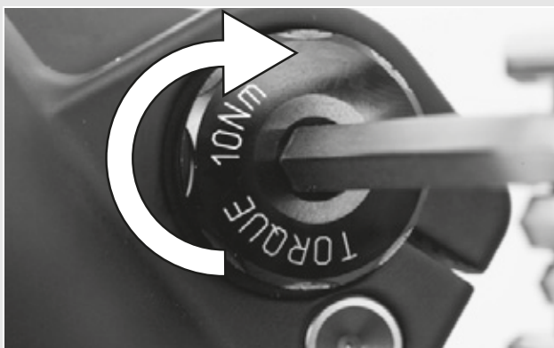
Illustration 32 : Serrer l'axe inséré
