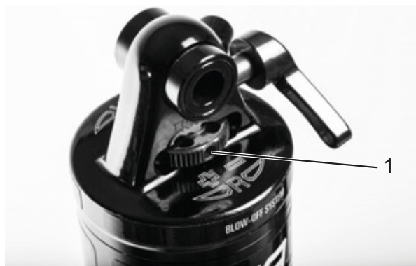
Illustration 64 : Molette de réglage de la détente Suntour (1) sur l'amortisseur arrière
