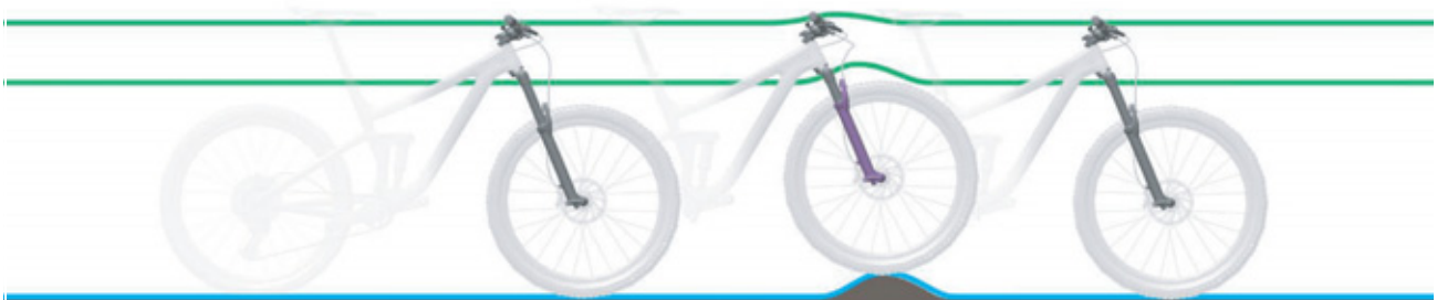
Figura 7: Condición óptima de marcha de la horquilla en caso de irregularidades
