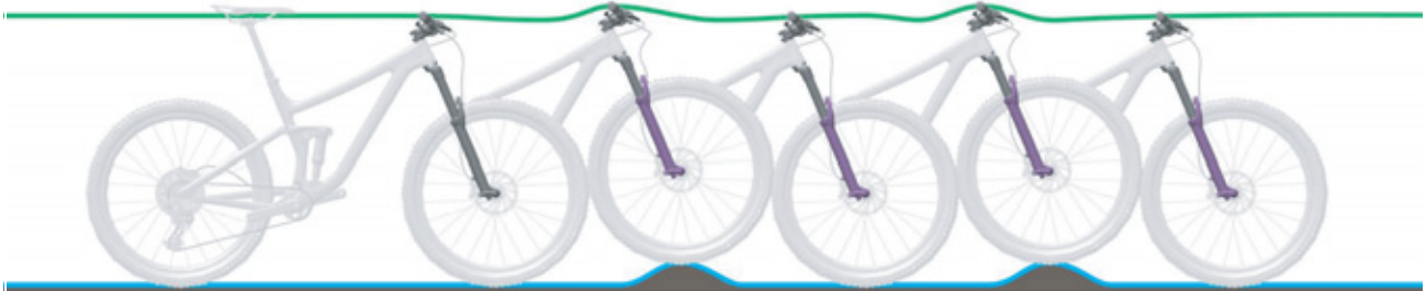
Figura 5: Condición óptima de marcha de la horquilla
