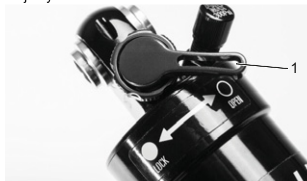
Obr. 77: Nastavovací šroub komprese Suntour otevřený (1)
