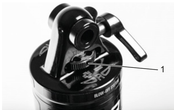
Obr. 61: Nastavovací šroub odskoku Suntour (1) na tlumiči zadního odpružení
