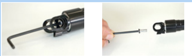
Illustration 192 : Retirer le capuchon de valve
