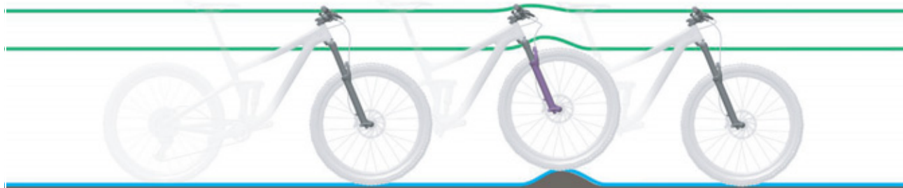
Illustration 11 : Comportement optimal de la fourche sur les irrégularités
