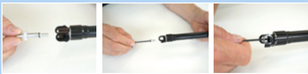
Illustration 191 : Fixer le couvercle de valve de la cartouche
