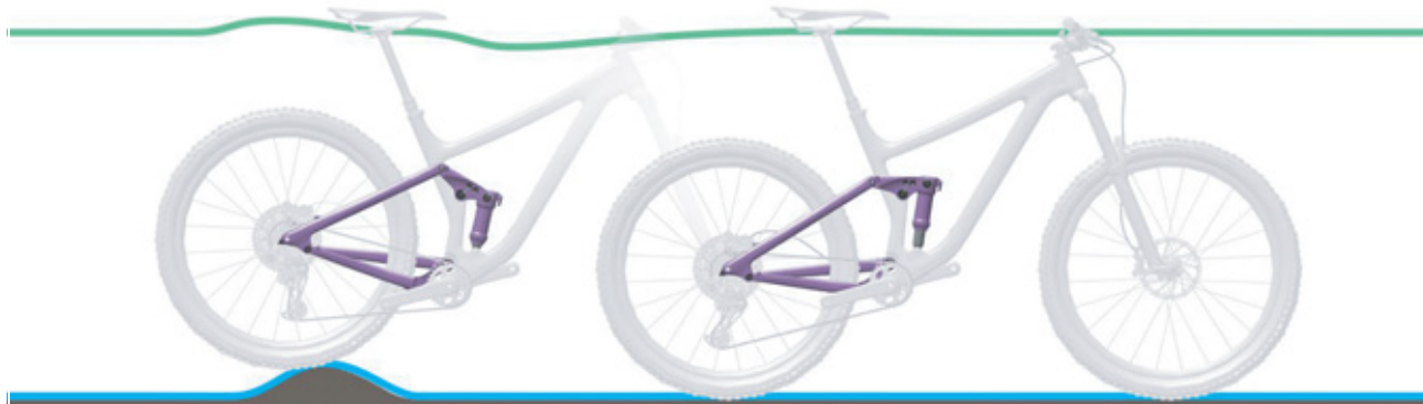
Illustration 111 : Comportement optimal de l'amortisseur arrière sur des irrégularités
