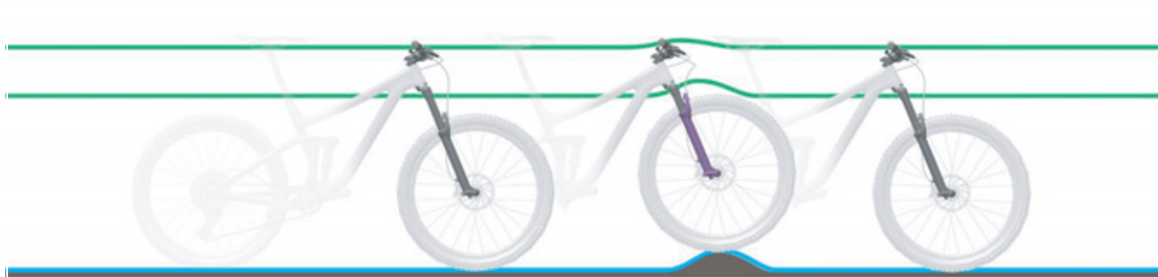
Illustration 148 : Comportement optimal sur les irrégularités
