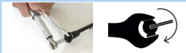
Illustration 194 : Régler dans le sens des aiguilles d'une montre
