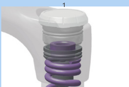
Illustration 99 : Serrer et desserrer l'anneau de réglage de la prétension
