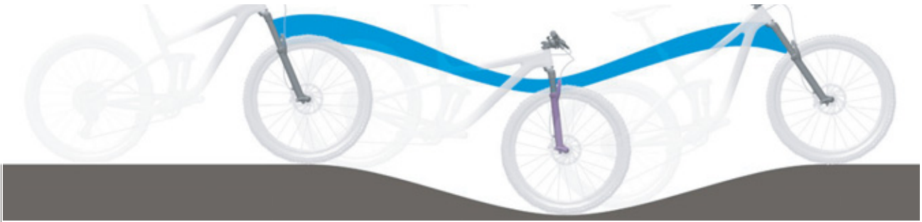
Illustration 238 : Suspension trop souple de la fourche suspendue dans les côtes
