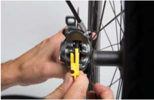
Illustration 161 : Contrôler la plaquette de frein montée à l'aide de la cale de transport
