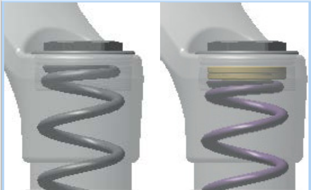
Illustration 91 : Serrer et desserrer l'anneau de réglage de la prétension
