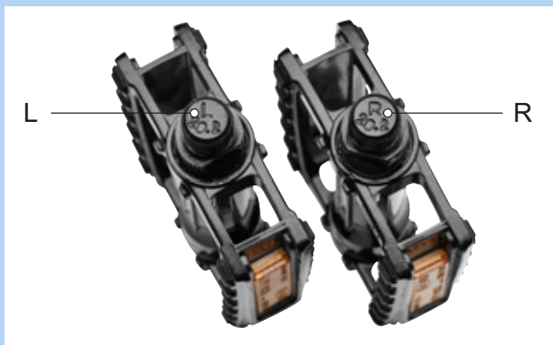
Illustration 58 : Exemple de marquage de pédales
