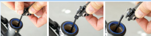
Illustration 213 : Retirer le câble Bowden
