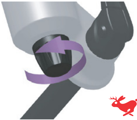
Illustration 237 : Tourner la vis de détente vers le lièvre
