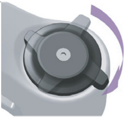
Illustration 239 : Régler le dispositif de réglage de la compression sur un niveau plus dur
