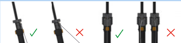
Illustration 199 : Câble Bowden correct et incorrect
