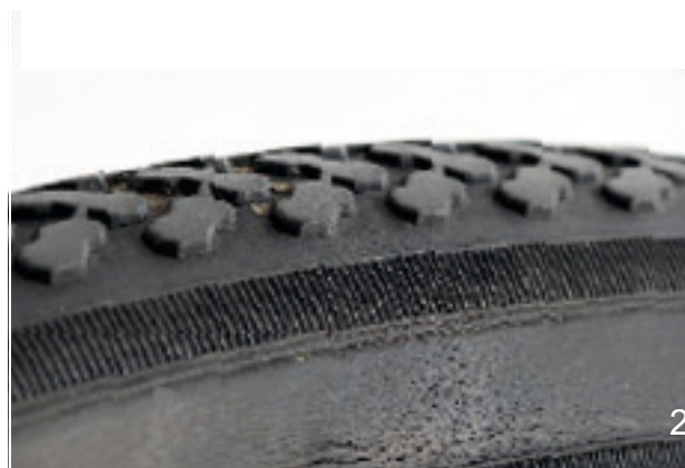
Illustration 160 : Exemples de fissures de fatigue (1) et de fissures d'âge (2)
