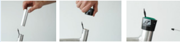
Illustration 229 : Monter la douille de glissement et l'enveloppe extérieure
