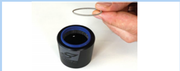
Illustration 216 : Rondelle élastique retirée
