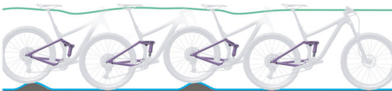
Illustration 16 : Comportement optimal de l'amortisseur arrière
