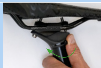
Illustration 228 : Fermer le réglage de la hauteur
