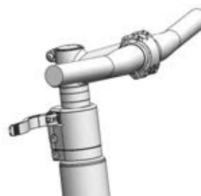
Illustration 152 : All Up avec levier de serrage de la potence ouvert
