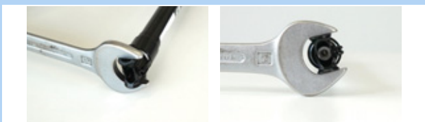
Illustration 193 : Empêcher l'interface de montage de tourner
