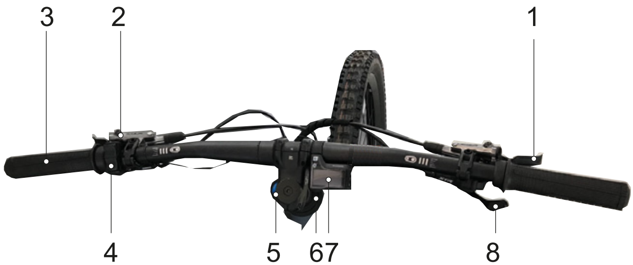
Illustration 45 : Vue détaillée d'un guidon avec ordinateur de bord SHIMANO SC-E800, exemple
