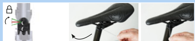
Illustration 209 : Fermer le réglage de la hauteur
