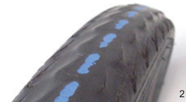
Illustration 159 : Pneu sans profil pouvant encore être utilisé (1) et pneu avec bande de protection visible (2) devant être changé
