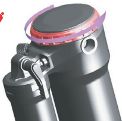
Paveikslėlis 110: Atšokimo pakopos reguliatoriaus pasukimas link kiškio
