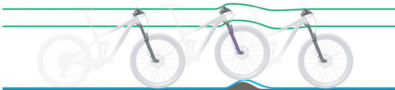
Paveikslėlis 105: Per kietas amortizuojančių šakių slopinimas nelygumuose
