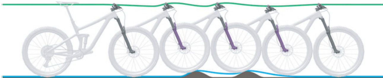
Paveikslėlis 101: Per lėtas amortizuojančių šakių atšokimas
