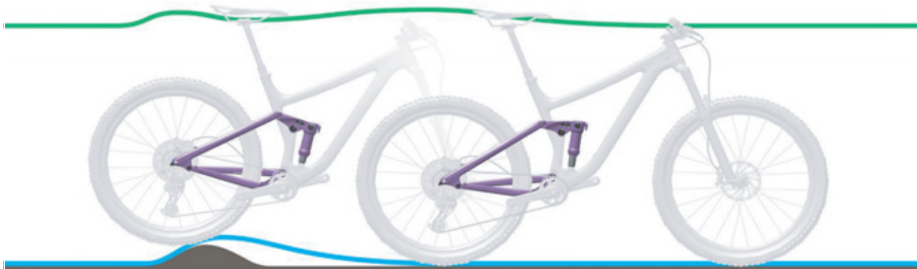
Paveikslėlis 113: Per kietas galinio amortizatoriaus amortizavimas nelygumuose
