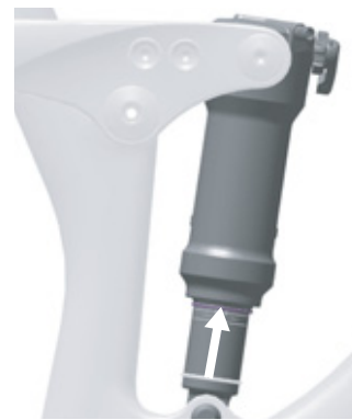
Paveikslėlis 57: Žiedinės tarpinės pastūmimas ant galinio amortizatoriaus
