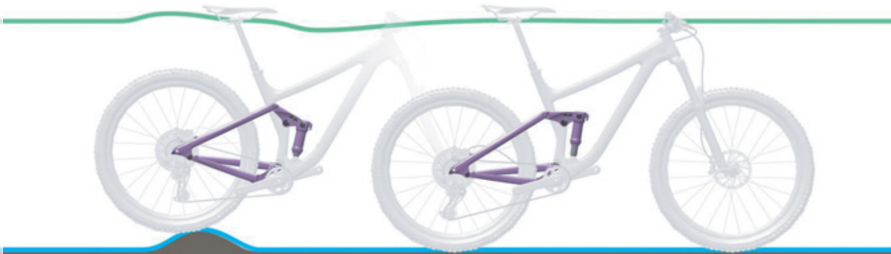
Paveikslėlis 64: Optimali galinio amortizatoriaus važiavimo charakteristika nelygumuose
