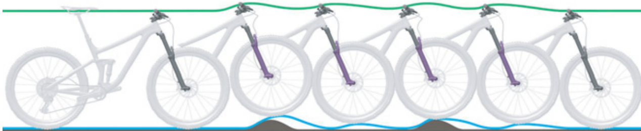
Paveikslėlis 99: Per greitas amortizuojančių šakių atšokimas
