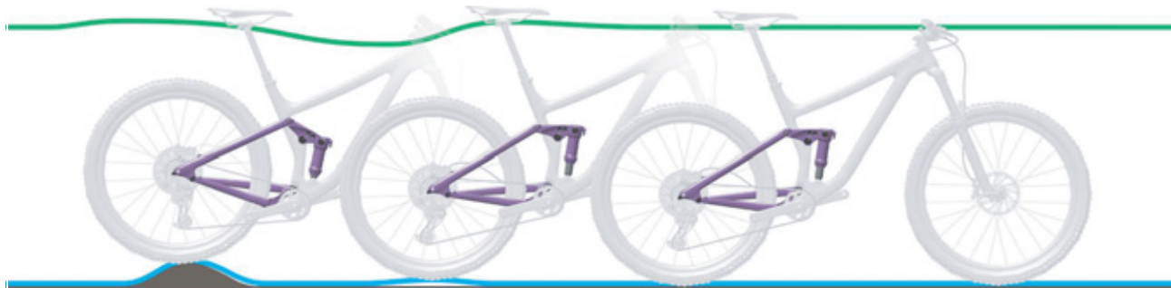
Paveikslėlis 107: Per greitas galinio amortizatoriaus atšokimas
