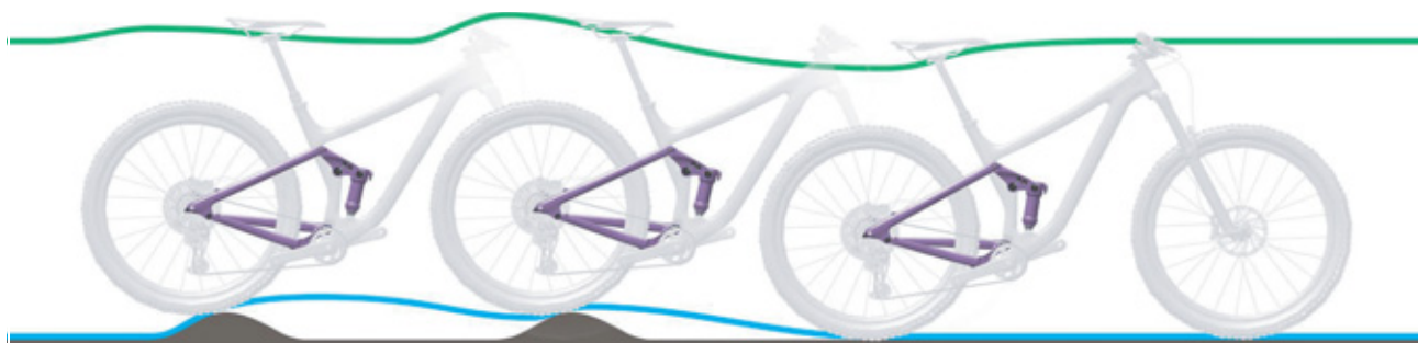
Paveikslėlis 109: Per lėtas galinio amortizatoriaus atšokimas
