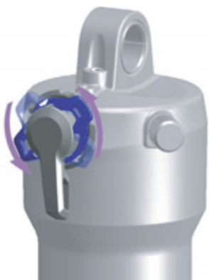
Paveikslėlis 66: Kompresijos reguliatorių nustatykite minkštesnėje padėtyje
