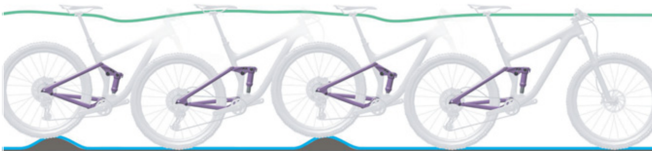
Paveikslėlis 59: Optimali galinio amortizatoriaus važiavimo charakteristika
