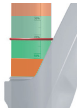
Paveikslėlis 55: Normatyvinis SAG diapazonas (žalias) ir draudžiamas AG diapazonas
