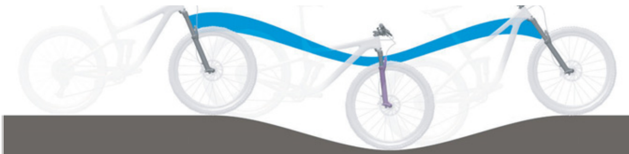
Paveikslėlis 103: Ant kalno šakių amortizavimas per minkštas
