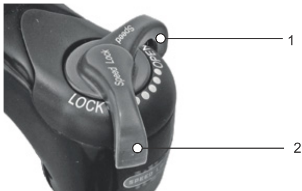
Paveikslėlis 88: „Suntour“ kompresiniai slopintuvai atviroje (1) ir uždaroje (2) padėtyje
