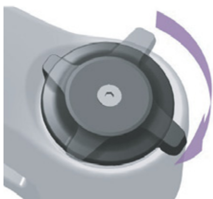
Paveikslėlis 104: Kompresijos reguliatorių nustatykite kietesnėje padėtyje
