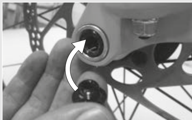
Figura 28: Inserción de la palanca de cierre rápido en el eje
