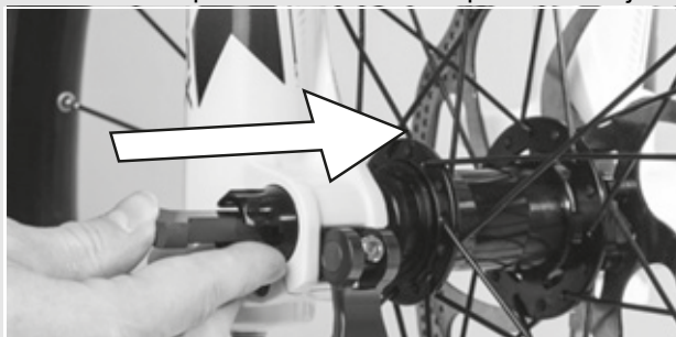
Figura 34: Inserción de la palanca de cierre rápido en el eje
