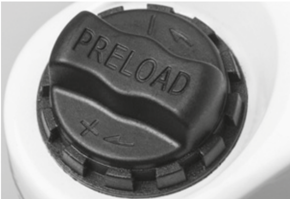
Figura 58: Rueda de ajuste del recorrido de muelle negativo en la corona de la horquilla de suspensión
