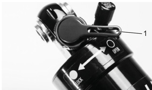
Figura 75: Regulador de niveles de presión Suntour abierto (1)
