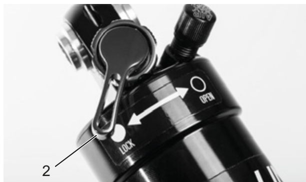
Figura 76: Regulador de niveles de presión Suntour cerrada (2)
