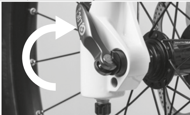
Figura 41: Cierre del cierre rápido
