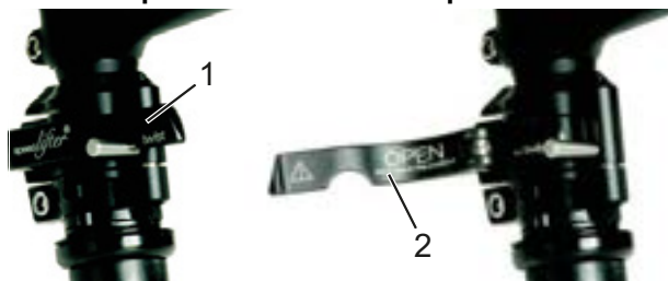
Figura 52: Palanca tensora de la potencia cerrada (1) y abierta (2), ejemplo by.schulz speedlifter
