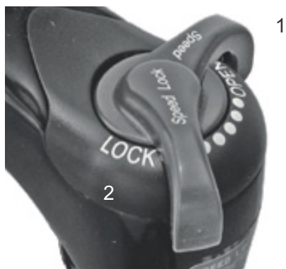
Figura 74: Regulador de niveles de presión Suntour con las posiciones OPEN (1) y LOCK (2)
