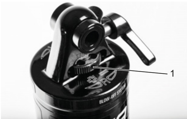
Figura 62: Rueda del regulador de niveles de tracción Suntour (1) en el amortiguador de la horquilla trasera
