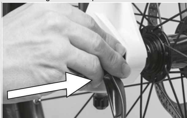
Figura 39: Inserción del cierre rápido
