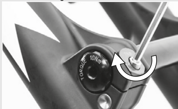
Figura 31: Apretar la abrazadera de sujeción
