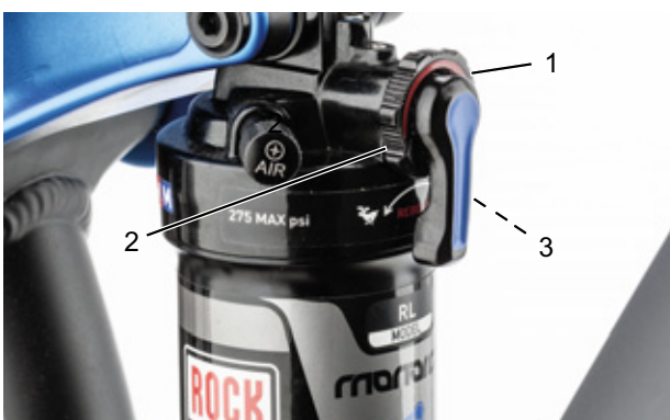
Figura 80: Ajuste de la dureza del amortiguador de niveles de tracción en la rueda de ajuste (1) del amortiguador de la horquilla trasera
