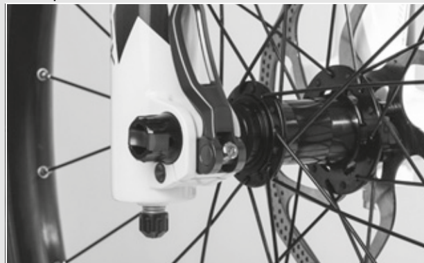
Figura 36: Posición perfecta de la palanca tensora
