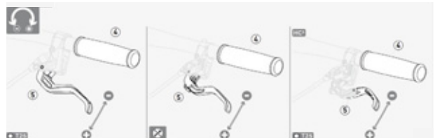
Figura 56: Ajustar el ancho de agarre de la palanca de freno con freno de disco Magura
