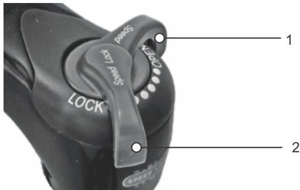
Obr. 95: Nastavovací šroub komprese Suntour s polohami OPEN (1) a LOCK (2)
