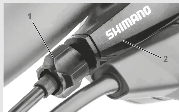
Obr. 103: Seřizovací pouzdro (1) řazení převodů ovládané jedním lankem s řadicí páčkou (2), příklad
