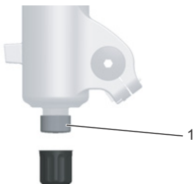
Obr. 74: Nastavovací šroub odskoku FOX (1) na patce nohy vidlice
