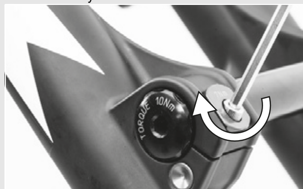
Obr. 45: Utažení pojistné svorky
