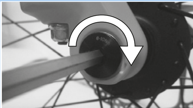
82. ábra: A tengely meghúzása nyírányban
