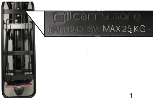
158. ábra: A csomagtartón fel van tüntetve maximális teherbírása (1)
