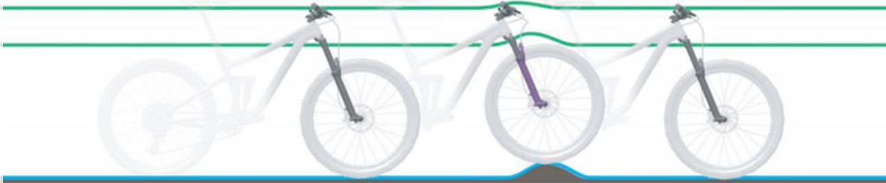
133. ábra: A villa optimális menetviselkedése egyenetlenségek esetén
