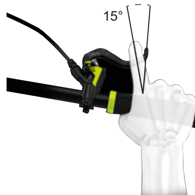
126. ábra: A kézifék pozíciója
