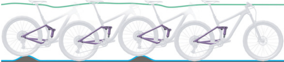
136. ábra: A hátsó lengéscsillapító optimális menetviselkedése
