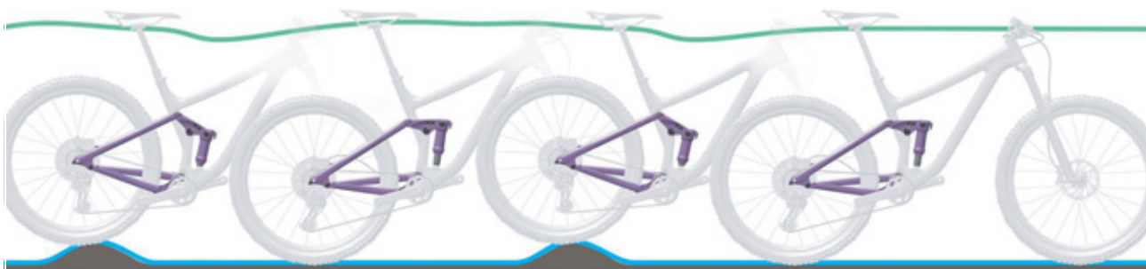
5. ábra: A hátsó lengéscsillapító optimális menetviselkedése
