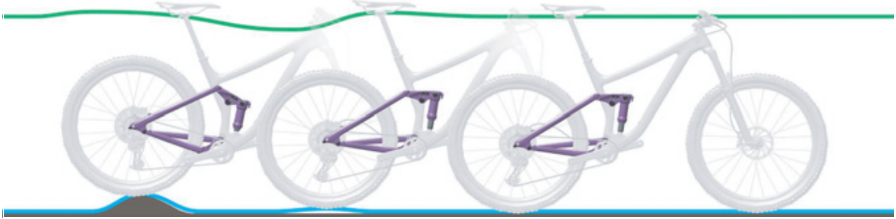
225. ábra: A hátsó lengéscsillapító túl gyors kirugózása
