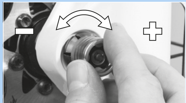
93. ábra: A feszítés beállítása
