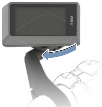
150. ábra: A kijelző elforgatása az óramutató járásával egyező irányban
