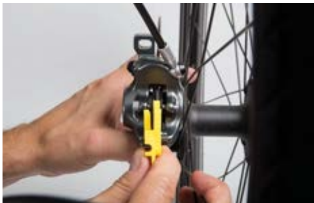
187. ábra: Fékbetét ellenőrzése beépített állapotban a szállítási rögzítés segítségével
