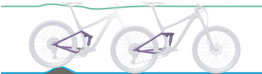
138. ábra: A hátsó lengéscsillapító optimális menetviselkedése egyenetlenségeknél
