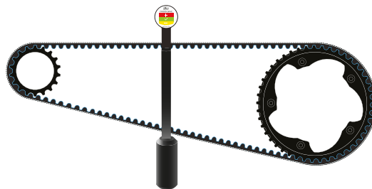
206. ábra: Felfüggesztett mérőrúd
