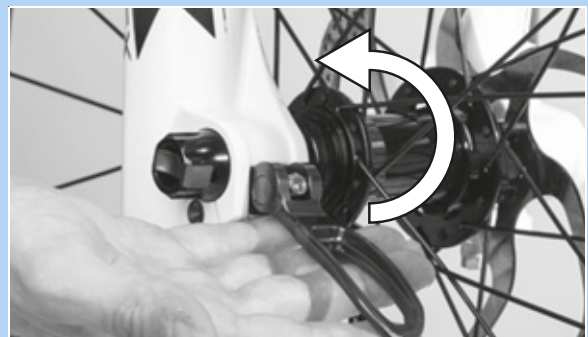
88. ábra: A gyorszár nyomása nyílrányban
