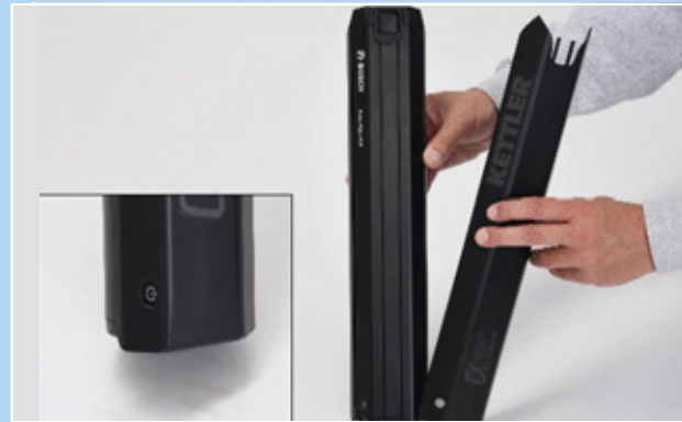
75. ábra: Az akkumulátorfedél rátolása az akkumulátorra
