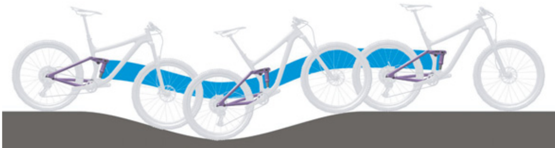
137. ábra: A hátsó lengéscsillapító optimális menetviselkedése dombos terepen
