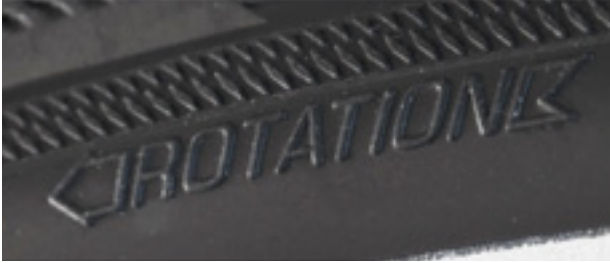
95. ábra: Futásirányjelző nyíl
