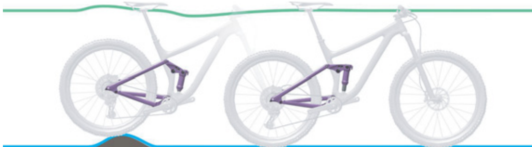
7. ábra: A hátsó lengéscsillapító optimális menetviselkedése egyenetlenségeknél
