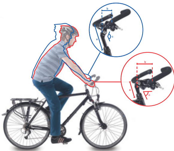
122. ábra: Városi kerékpár (kék) és túrakerékpár (piros) a szög változtatásával
