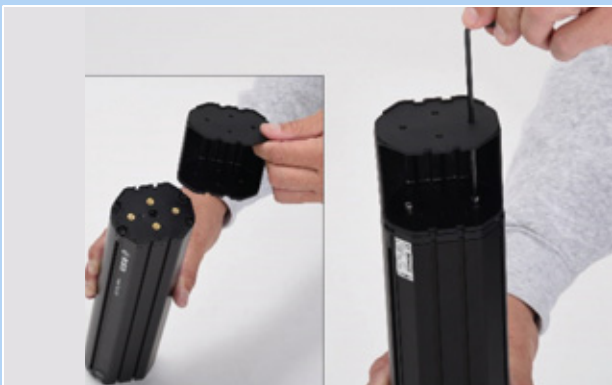
77. ábra: PowerTube hosszabbító beszerelése
