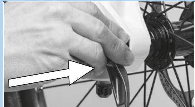
92. ábra: A gyorsár betolása nyil irányban
