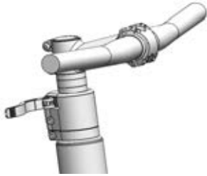
178. ábra: Példa: All Up nyitott kormányzár gyorskioldóval
