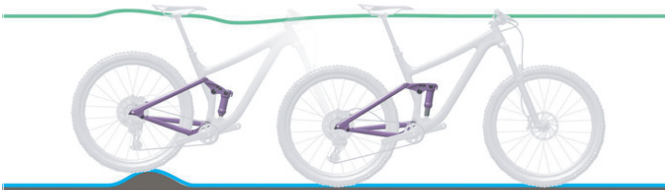
165. ábra: A hátsó lengéscsillapító optimális menetviselkedése egyenetlenségeknél
