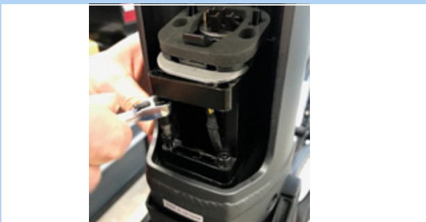
68. ábra: A 4 mm-es hatlapfejű csavarok eltávolítása
