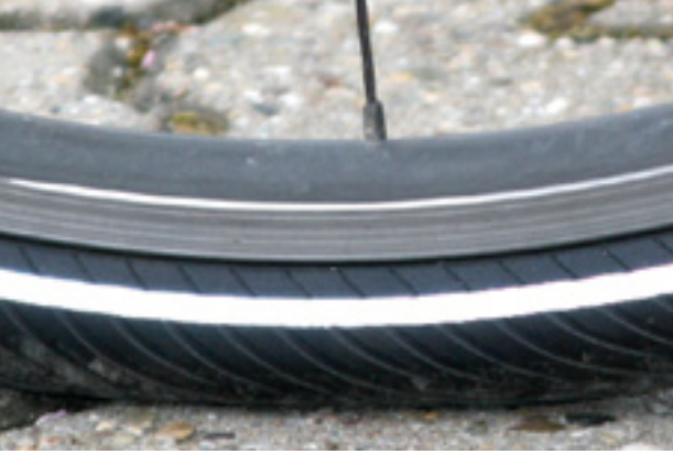
124. ábra: Helyes töltőnyomás. A gumiabroncs alakja a testsúly terhe alatt alig változik
