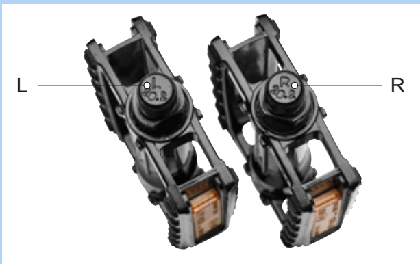
97. ábra: Példa: pedálok jelölése
