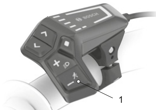
173. ábra: A tolási rásegítés gomb elhelyezkedése (1)
