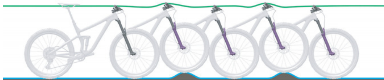
131. ábra: A villa optimális menetviselkedése
