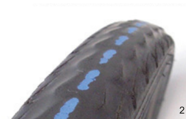
185. ábra: Profil nélküli gumiabroncs, amelyet cserélni lehet (1), és gumiabroncs áttetsző defektvédelemmel (2), amelyet cserélni kell
