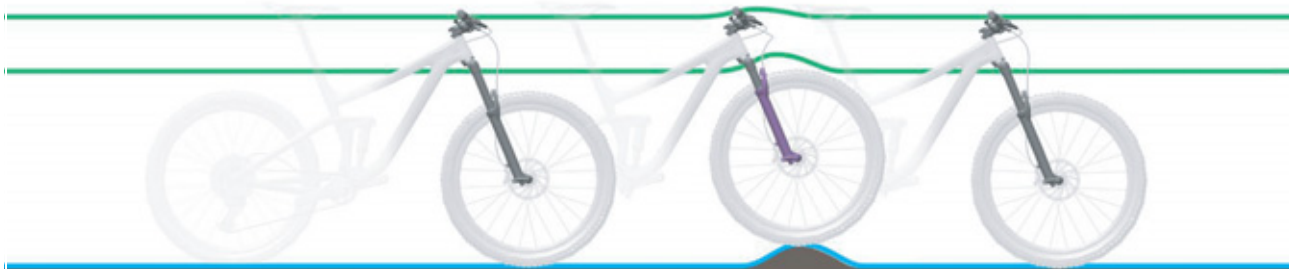
18. ábra: A villa optimális menetviselkedése egyenetlenségek esetén
