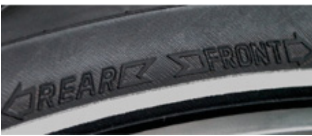
96. ábra: Futásirányjelző nyíl MTB gumiabroncsokon
