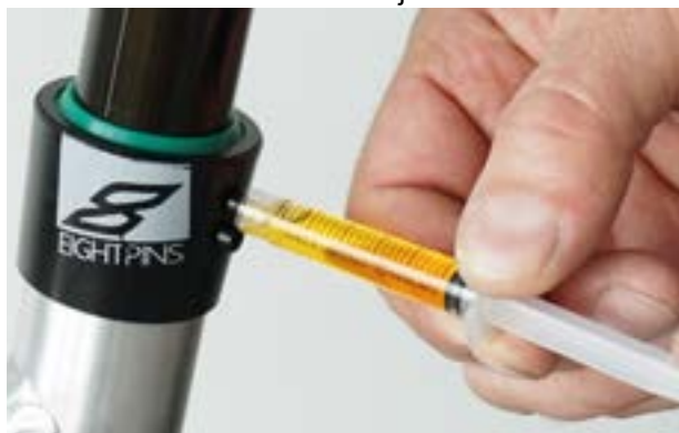
183. ábra: eightpins nyeregcső kenése
