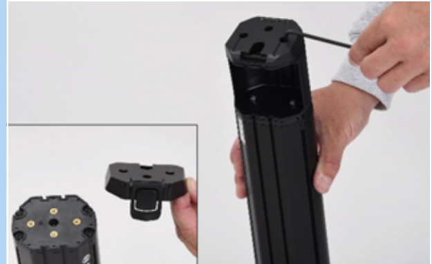
78. ábra: Akkumulátor-szerelőlemez csavaros rögzítése
