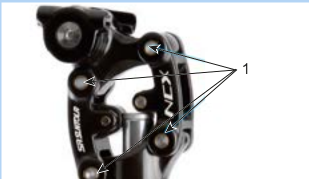
217. ábra: SR SUNTOUR rugós nyeregcső kenőpontjai
