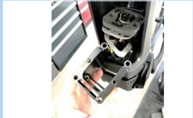
70. ábra: A PowerTube adapter kihúzása
